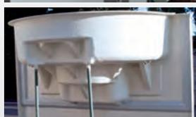
Extrem steife Treppenkonstruktion durch mehrschichtiges Glasfaserverbundmaterial mit integrierten Knotenprofilen.
